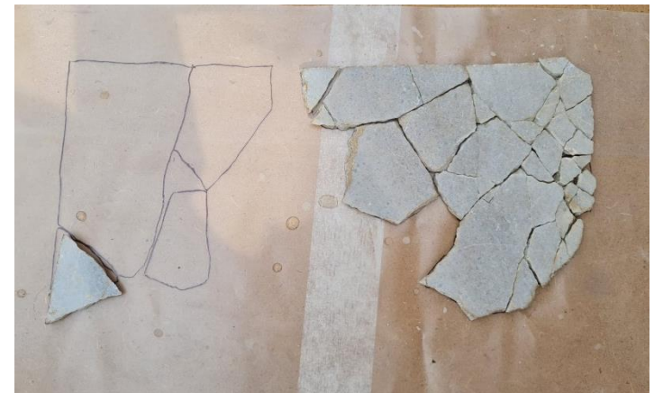
Opus sectile in ardesia e marmo bardiglio Consolidamento esfoliazione, incollaggio lastre fratturate e riallettamento
